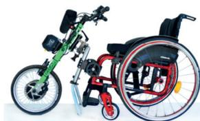
4.5.2 Zuggerät vom Rahmen entkoppeln - Anklemmanbindung
