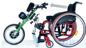
6. Zuggerät befindet sich in Fahrposition.
