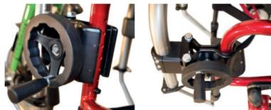
3. Die Hebel an beiden Seiten fest drehen und einklappen. (Bild 2 Hebel ausgeklappt)
