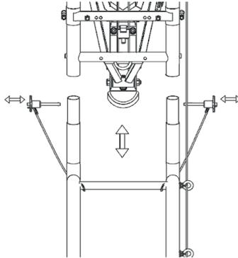
Achten Sie darauf, daß die Steckachsen immer eingerastet sind und die Schlepliftfernauslösung eingehakt ist.
